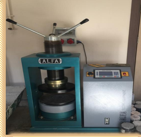
Beton Basınç Dayanım Test Presi
